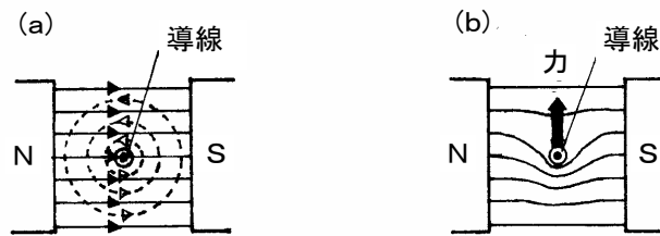
図 11 磁石の磁界と導線の磁界により生じる電磁力の方向：(a) 実線は磁石により生じる磁力線，破線は導線により生じる磁力線，(b) 合力の磁力線と電磁力の方向
