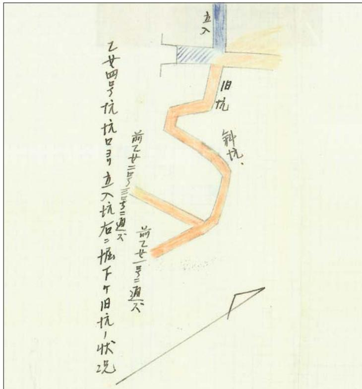
(B) 乙女坑の旧斜坑のスケッチ図
