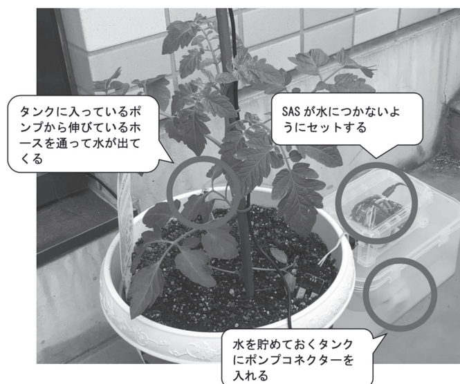
図3 SASを使った灌水の仕組み
