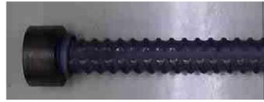
図 2-16 実験に用いた機械式定着<sup>28)</sup>
