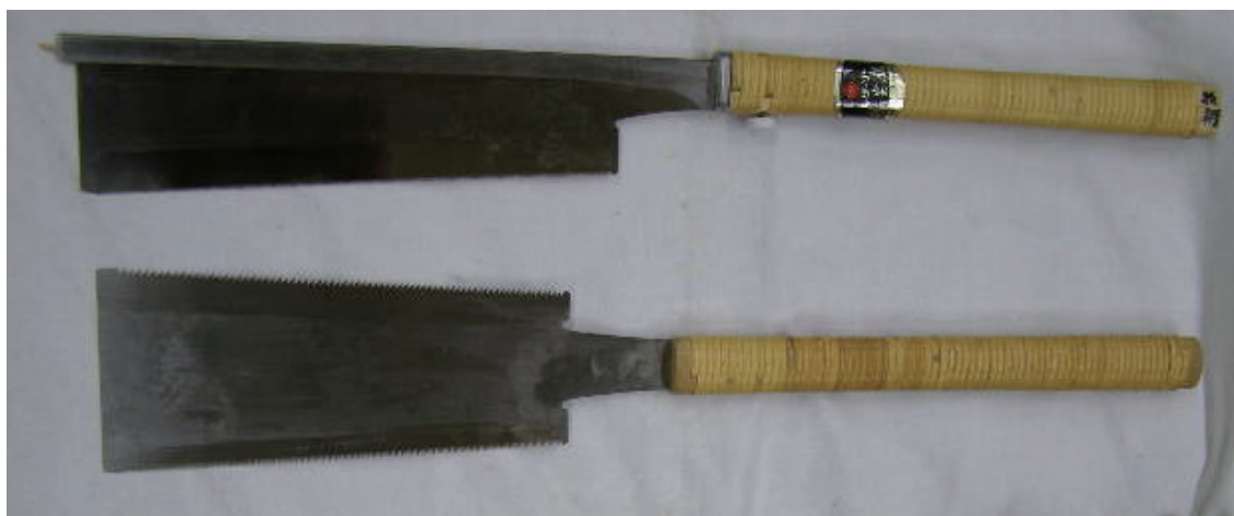
図8 現在の日本の鋸；片刃（上段）， 両刃（下段）
