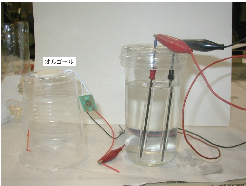
図3 作製した燃料電池によるオルゴール演奏
