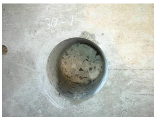
図-6.21 付着強度試験(母材破断)
