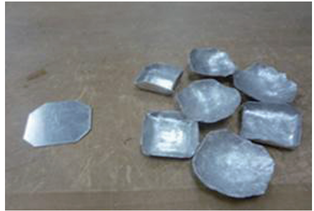
写真4 鍛造前（左）と鍛造後（右）のアルミニウム板
