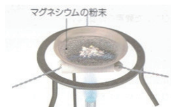
図4 ステンレス皿上でのマグネシウムの燃焼 （東京書籍「新しい科学2」より）
