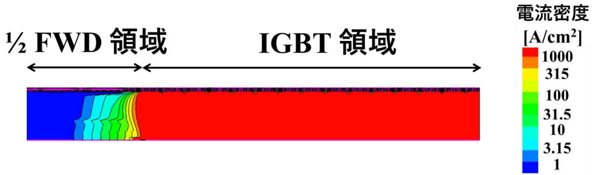
図 5-17 : 電流分布 (リボン、IGBT 通電、 R_{\text{wire}} = 5 \times 10^{-2} \Omega )
